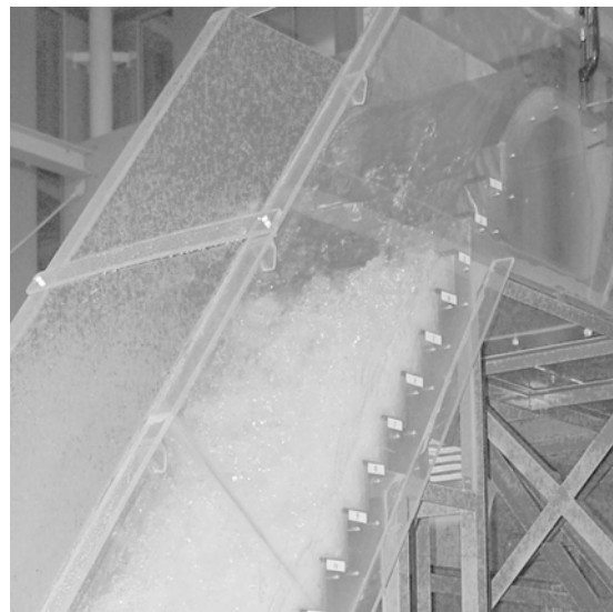
写真-1 階段状水路の Skimming flow
