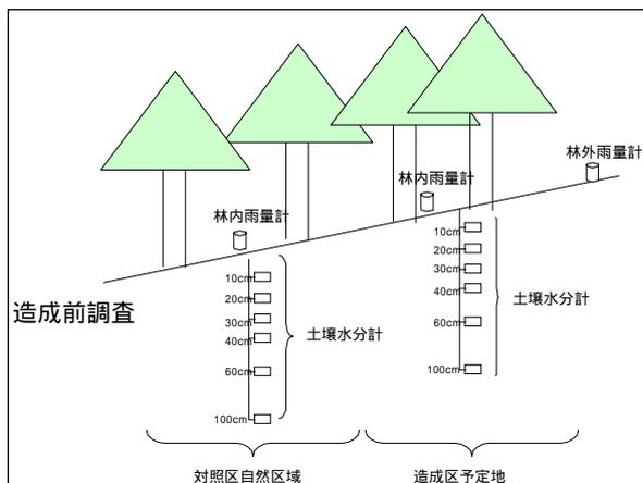
図1. 土壌水分センサーの設置状況
