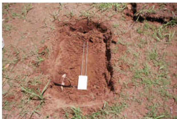
写真 1 TDR 土壌水分計の埋設状況
