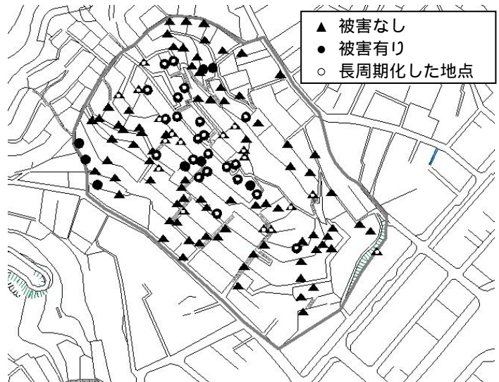
図-1 常時微動測定地点（両城地区周辺）
