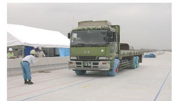
写真 - 2 荷重試験状況
