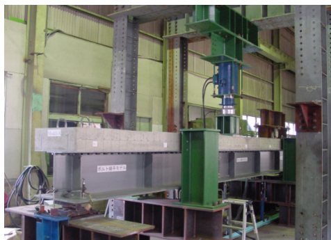
写真－1 合成桁の載荷実験状況
