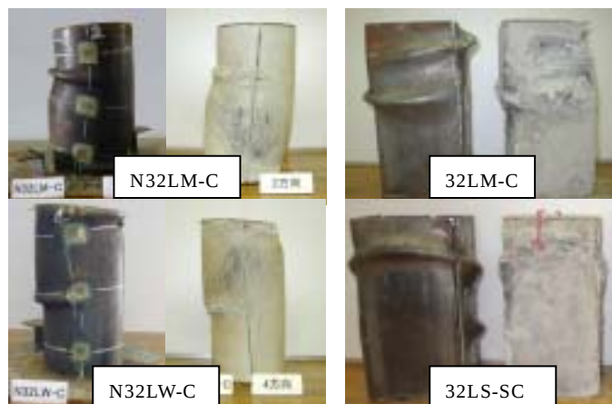
(a)円形CFT,RCFT試験体 (b)角形CFT,RCFT試験体 写真-1 柱試験体の破壊性状
