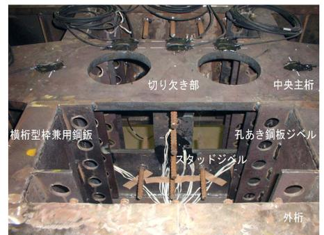
写真-1 中央主桁部の切り欠き状況
