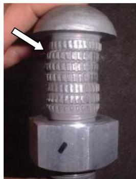
(a) 打込みボルトの破壊状況
