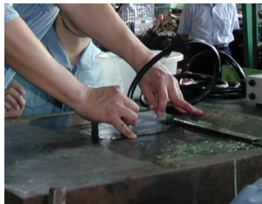
写真－2 フェイズドアレイ探傷状況
