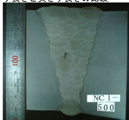
写真-3 破壊試験マクロ写真
