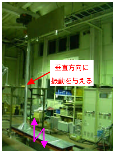
写真-1 共振実験状況
