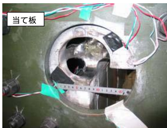
写真4 大コア法（板組 WF, FF）
