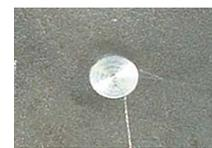
写真 1 R 試験体丸鋼充填部
