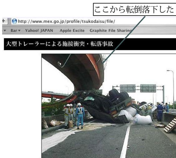
写真 2.1 実際の転倒落下事故
