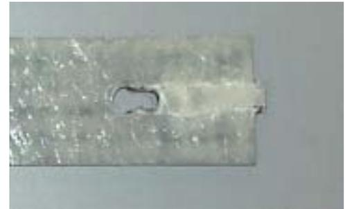
図-2(b) ボルト軸力有の破壊状況
