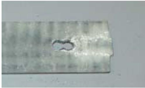
図-2(a) ボルト軸力無の破壊状況
