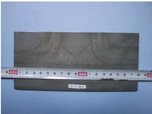
図-7 溶接施工試験状況（上:UT 検査，下:マクロ試験）
