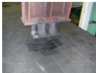
写真-2 試験終了後の舗装面
