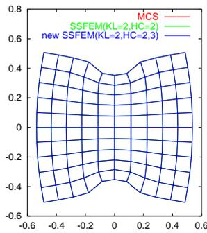
図-1 MCS, SSFEM (KL=2, HC=2) 及び提案する SSFEM (KL=2, HC=2,3) により算出された変形の期待値の比較 .
