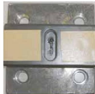
図-8: ストッパーボルト破断状況 (L2S2-G1)
