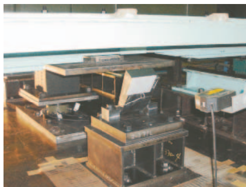
図-7: SB 供試体破断状況
