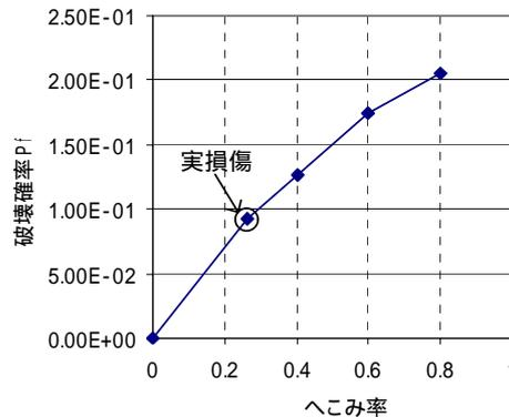
図-8 破壊確率～へこみ率関係
