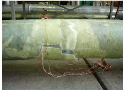
写真-1 座屈破壊
