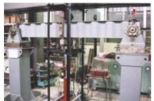
写真-1 横ねじれ座屈実験の全景
