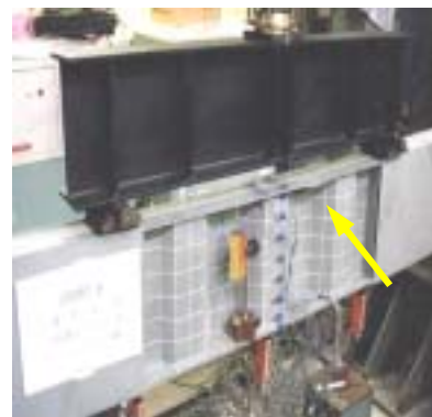
写真－2 崩壊状況
