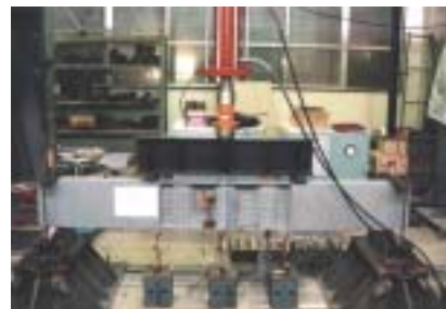
写真-1 純曲げ実験の全景
