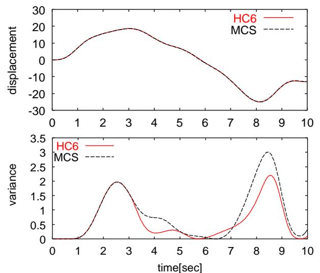
図-4 応答変位の時刻歴 (バイリニア型モデル, 上: 期待値, 下: 分散)
