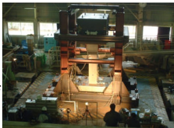
写真-1 振動台と実験供試体
