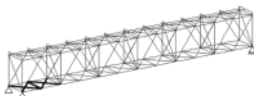
図-7 座屈拘束ブレース配置位置
