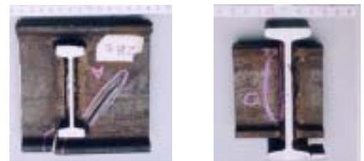
写真-2(a)主部材破断 写真-2(b)横主部破断
