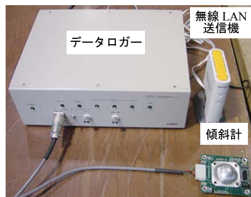
図-2 モニタリングシステム送信部
