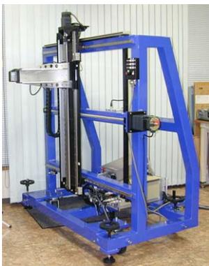
図-1 表面粗さ計測装置
