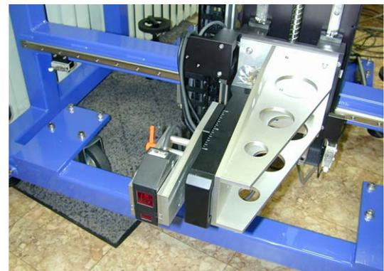
図-3 レーザー変位計(Z軸)
