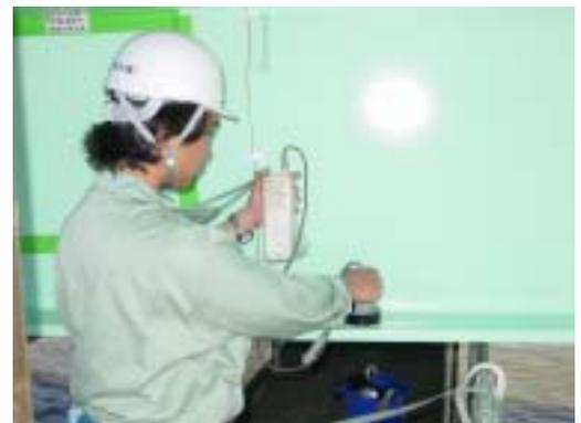
写真-3 表面塩分計による測定
