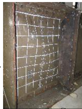
図 7 変形図と実験によるウェブの変形状況
