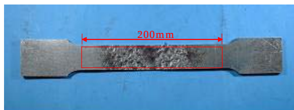
写真 1 腐食鋼板試験片
