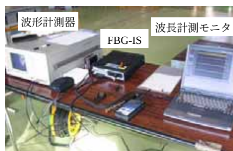
写真1 計測システム
