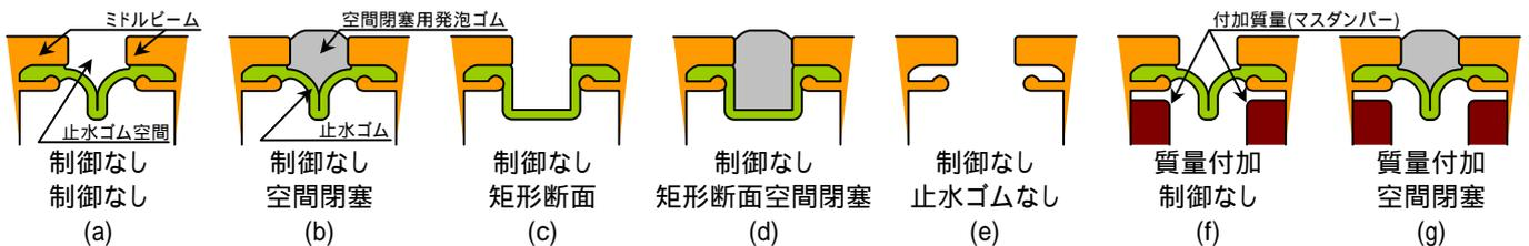
図3 騒音制御条件(上段:振動制御策，下段:空間制御策)
