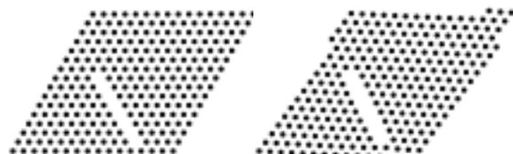
図-6  $r_3$  方向に欠陥を有する RVE の変形
