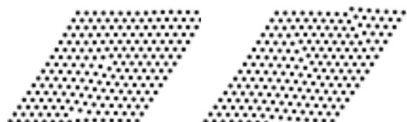
図-7  $r_2$  方向に欠陥を有する RVE の変形
