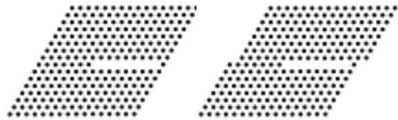
図-5  $r_1$  方向に欠陥を有する RVE の変形
