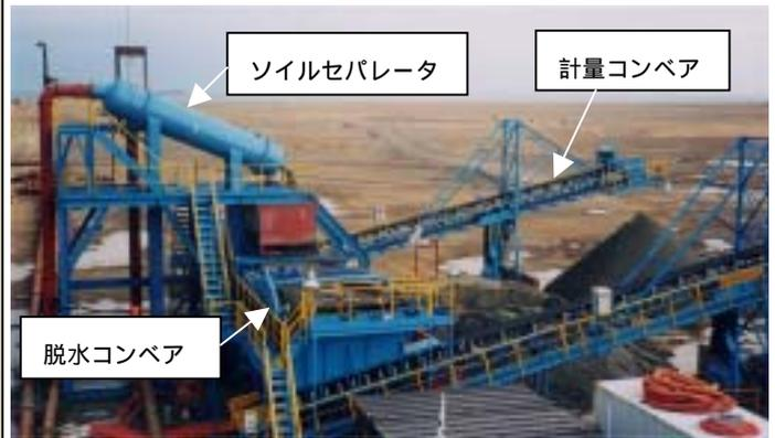
写真 - 1 分級・脱水・計量設備
