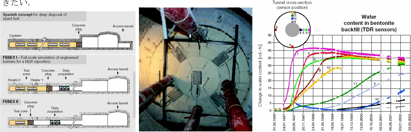
図一3 FEBEX 試験（実規模人工バリア熱応力水理試験）左・中：試験レイアウト他，右：飽和度経時変化
