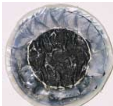
写真-2 試験体（シート系防水材）
