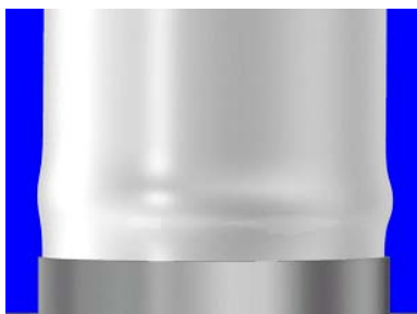
図 4 局部座屈変形の CG 表示
