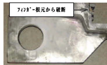
b) 供試体の切断面の状況
