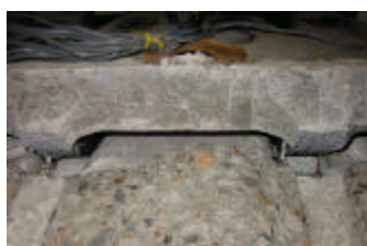
a) ジベルフィレット部からの破断状況
