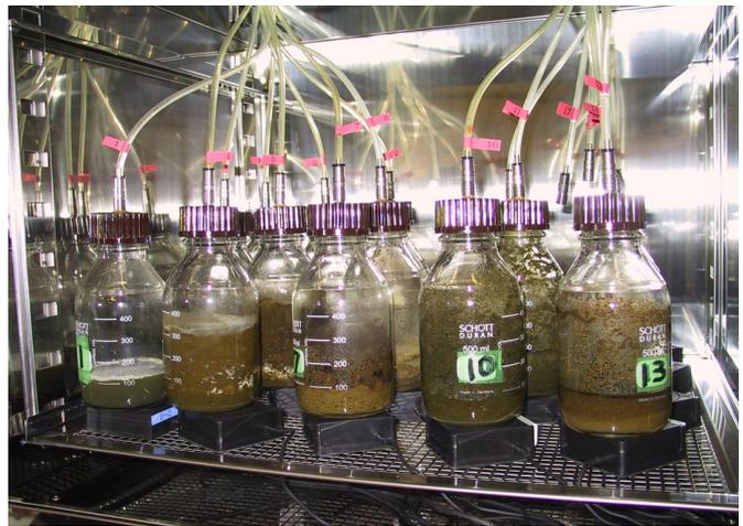
写真-1 半固体メタン発酵予備試験装置
