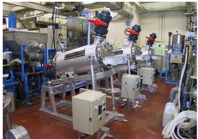
写真-2 半固体メタン発酵試験装置
