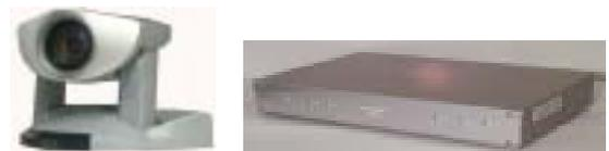
図-4 ネットワークカメラとカメラサーバ
