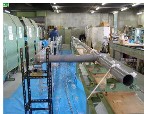
写真1 微気圧波模型実験装置概観
