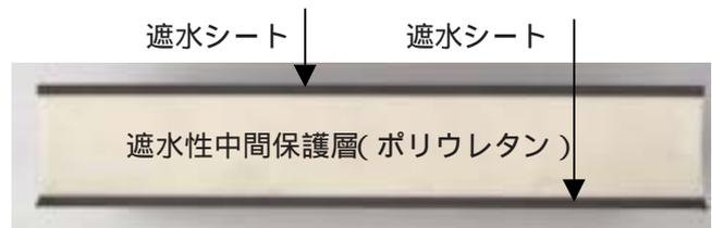
図 - 1 複合シート断面構造
