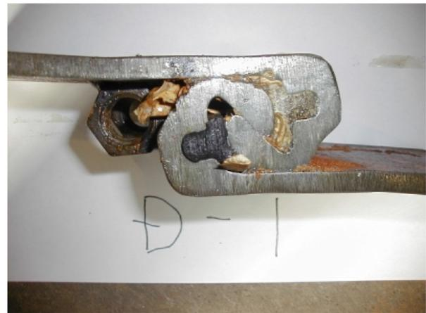
写真-2 透水試験後の嵌合部の状況 (Case3の場合)
