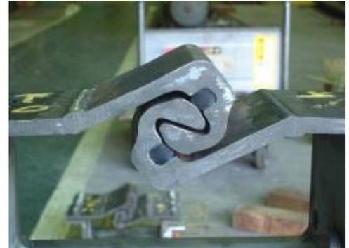
写真-1 継手底部に窪みを有する鋼矢板断面 (Case1の場合)
