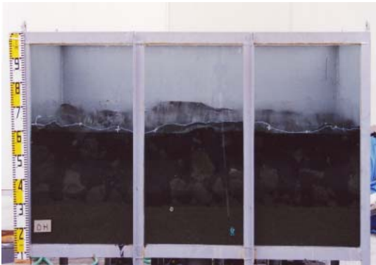
写真－1 アスファルトマスチック打設後(0h時)
