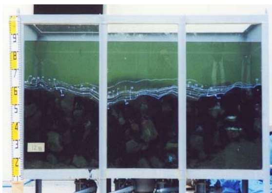
写真-2 アスファルトマスチック打設後(12日目)
