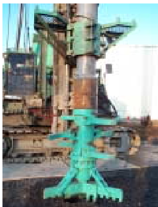
写真－1 掘削攪拌機
