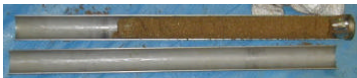
写真 - 1 緩い砂質土の試料採取状況
