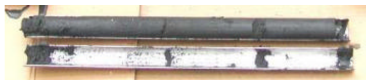
写真 - 2 粘性土の試料採取状況
