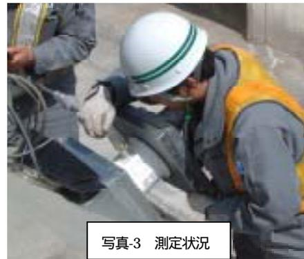
現地にはリング状部材が取り付けられているだけで、その他の電気信号ケーブルなどの電気配線、電源設備が皆無であり、アンカーヘッドなどと同等の数十年単位の耐久性がある。また、アンカーヘッドと支圧板（アンカープレート）との間に装着するためアンカータイプを選ばず任意の形式に対応可能である。
